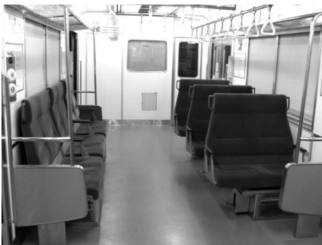
図5 2WAYシート、左側がロングシート、右側がクロスシート
