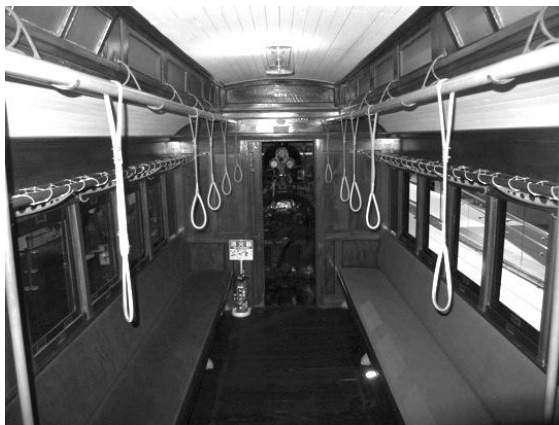
図2 図1の車両の室内、天井が2段になっていることがわかる(当会蔵)
