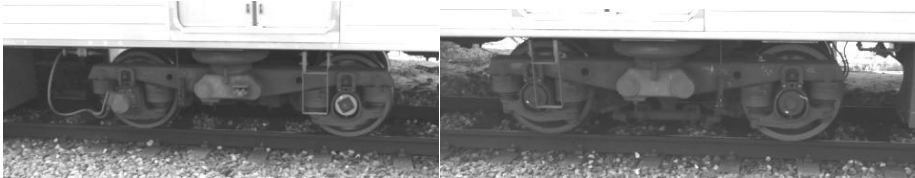
図8 205系のボルスタレス台車 (左)クハ204(TR235) (右)モハ204(DT50)
