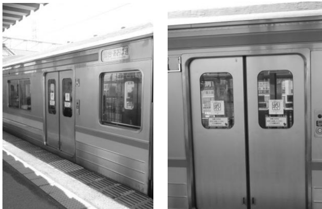
図7 窓の大きさが異なる2種類のドア (左)埼京線からの転属車 (右)山手線からの転属車
