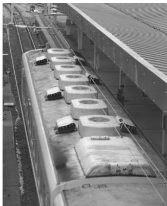
図14 屋根の両脇に並ぶ押込式ベンチレータ(写真はキハ58、当会蔵)
