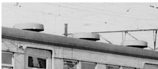
図13 グローブ式ベンチレータ(車両はクモハ11102)(当会蔵)
