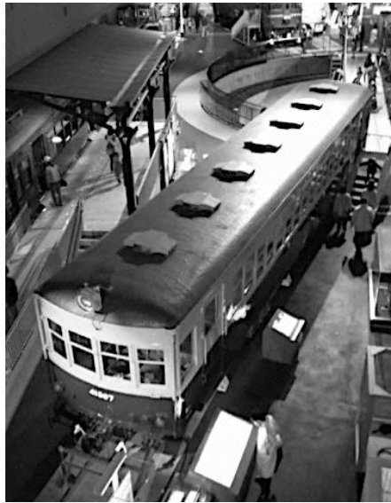
図17 屋根上に並ぶガーランド式ベンチレータ(写真はキハ41307、当会蔵)
