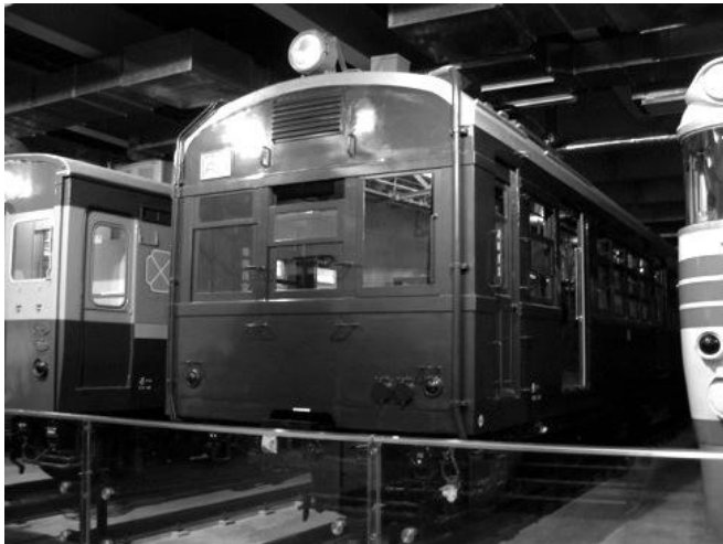
図18 前照灯の下にある63系電車の通風口(当会蔵)
