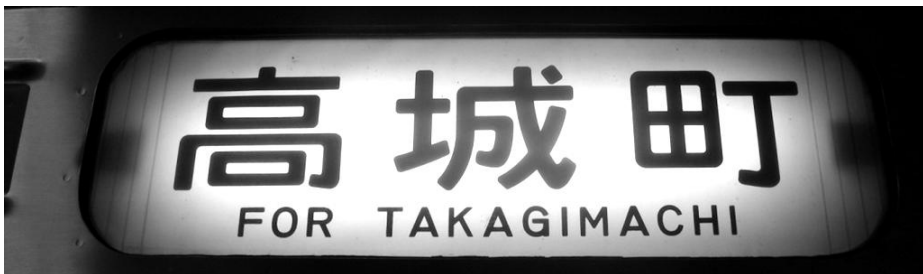
図10 3100番台の電圧比較型幕式側面行先表示器 フィルムの両側にマイクロスイッチがこすった跡が縦線として見える。
