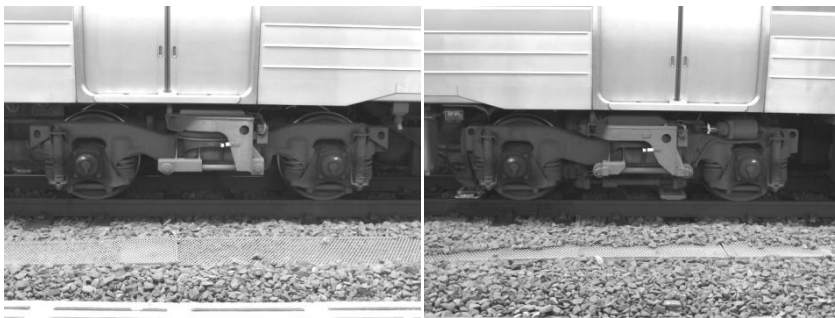
図9 ボルスタ付きの台車(写真は719系電車) (左)クハ718(TR69) (右)クモハ719(DT32)
