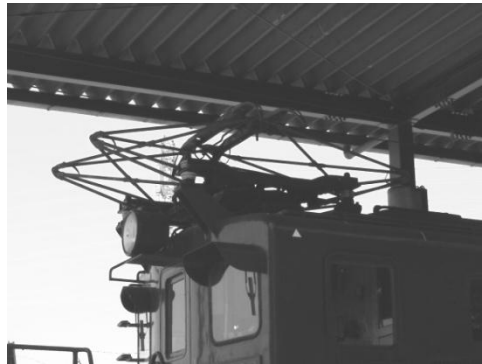
図 18 飛び出したパンタグラフ
