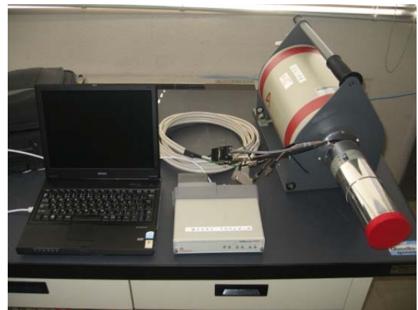
Fig. 4.2 ポータブルゲルマニウム半導体検出器
