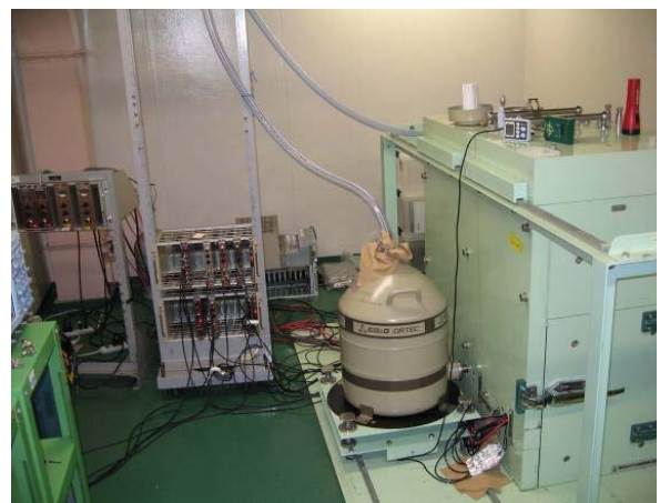
Fig. 4.3 低レベル放射能測定用 ゲルマニウム半導体検出器
