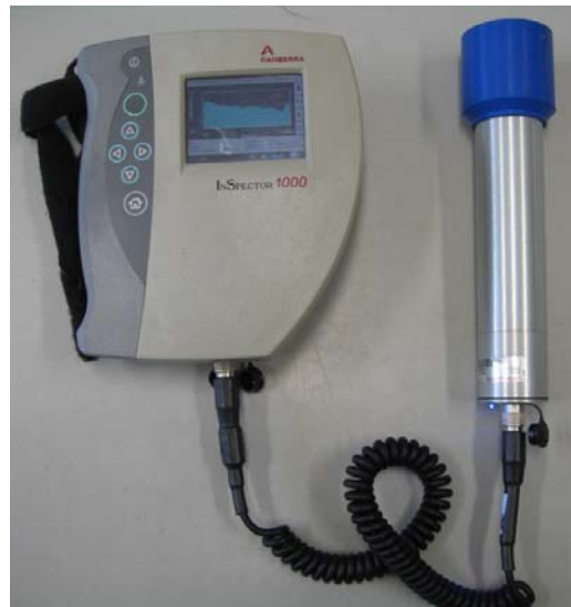
Fig. 4.1 \text{LaBr}_3 シンチレーション検出器
