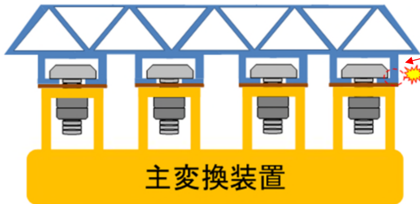
主変換装置取り付け状況
