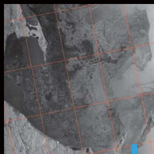
「だいち」搭載の高性能可視近赤外放射計2型（アブニール・ツー）により東日本大震災の被災地を緊急観測。アブニール・ツーは青域から近赤外域の電磁波を4つのバンドで観測することができる光学センサーで、人工衛星直下を観測の際には、幅70kmの範囲を地上10mで識別できる能力を持つ
