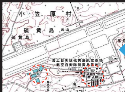
修正前の地形図（右）と、「だいち」のデータを元に修正された地形図（左） 飛行場、道路、建物などが修正されている 画像提供：国土地理院
