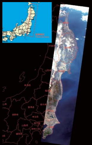
「だいち」搭載の高性能可視近赤外放射計2型（アブニール・ツー）により東日本大震災の被災地を緊急観測。アブニール・ツーは青域から近赤外域の電磁波を4つのバンドで観測することができる光学センサーで、人工衛星直下を観測の際には、幅70kmの範囲を地上10mで識別できる能力を持つ
