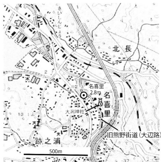
図2 和歌山県田辺市新庄村名喜里 この集落の一番海よりの街区の標高は2.3m。ここで0.5mの冠水があったとすると、津波高は2.8mとなる。
