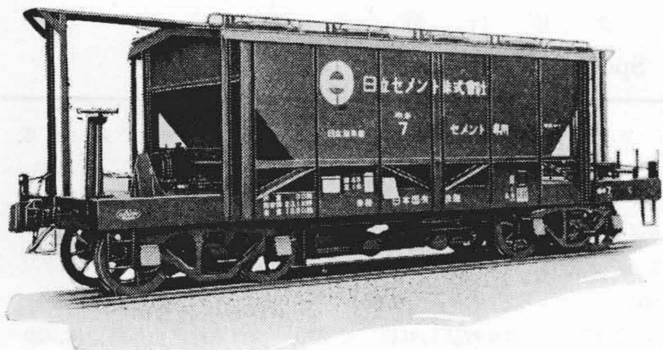
第 35 図 日立セメント納セメント運搬車 Fig. 35. Cement Car for Hitachi Cement Co.
