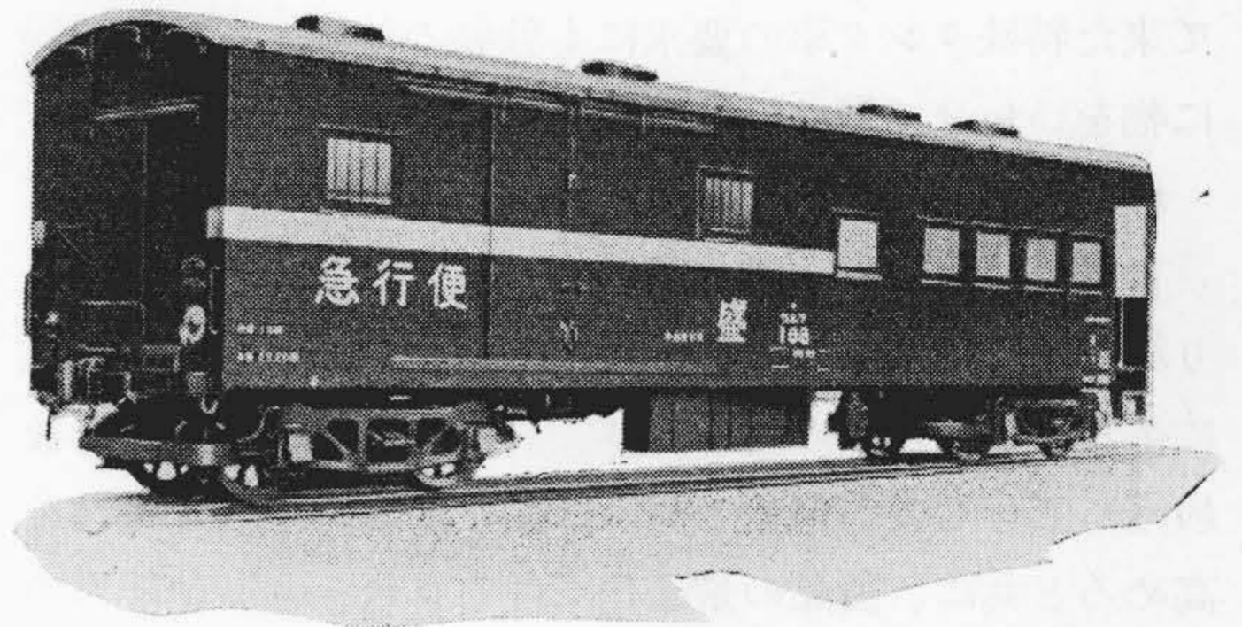
第29図 ワムフ100形二軸ボギー有蓋緩急車 Fig. 29. 8-Wheeled Covered Brake Wagon
