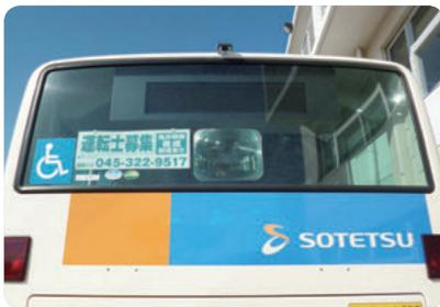
バックアイカメラを設置した車両
