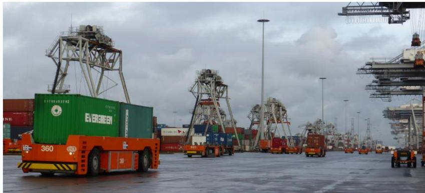
写真-3.1 世界初の自動化コンテナターミナル「Delta Terminal」(筆者撮影)
