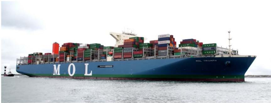
写真-3.3 MOL Triumph (長さ 400m, 幅 58.8m, 積載コンテナ数 20,170TEU)
