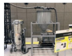
産業用のセントラルバキュームシステム。(左)各作業スペースで吸引したゴミは工場内にめぐらせた配管を通り、(上)1カ所に回収される
