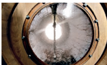
ノズルが回転し、ワイン樽の中を一気に洗浄
