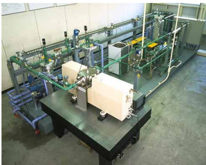
図3 CO 2 ヒートポンプループ試験装置 (出所：電力中央研究所ホームページ)
