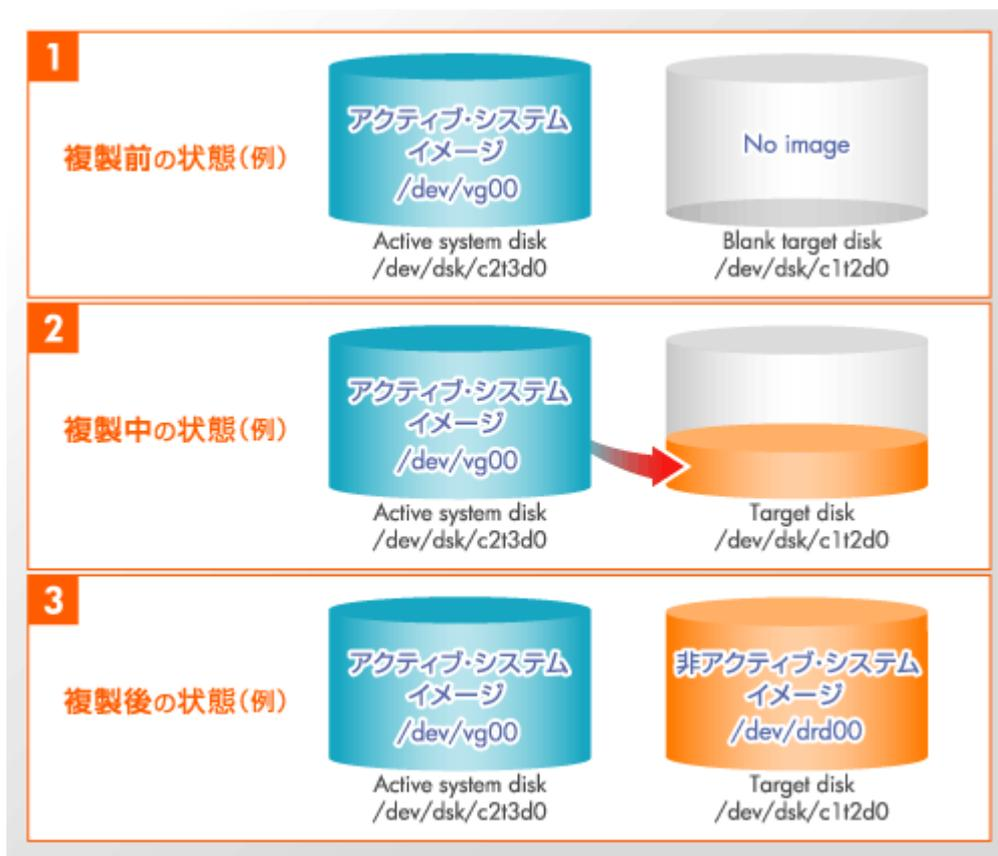
図 1 : DRD による複製の流れ
