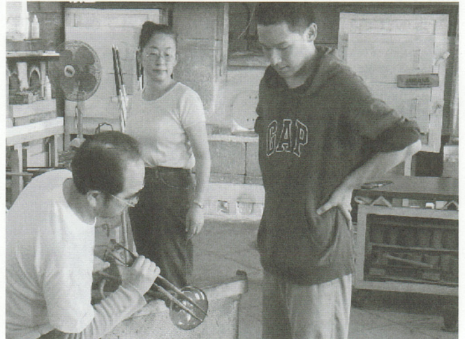
すべて手作業で行われる宙吹きガラス成形の様子
