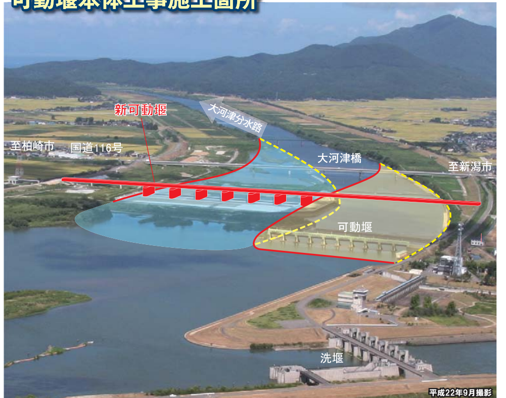
新可動堰は、現在の可動堰を機能させながらコストを軽減し、安全に工事ができるようにするため、現在の可動堰より400mほど下流の、河道中央(現在高水敷)に建設されます。
