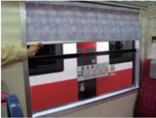
写真-3 車端寄り側窓を下降窓化
