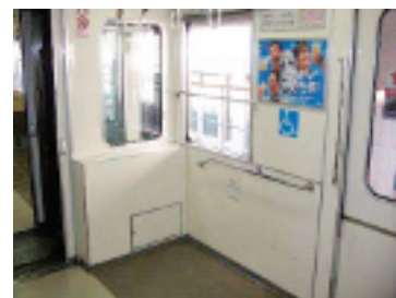
車椅子スペースの設置
