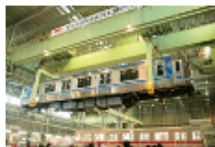
車体吊り上げ作業実演
