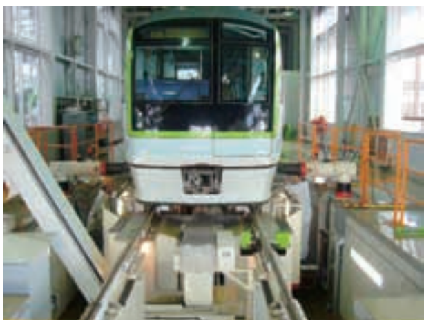
図11 在姿車輪削正装置における車輪削正
