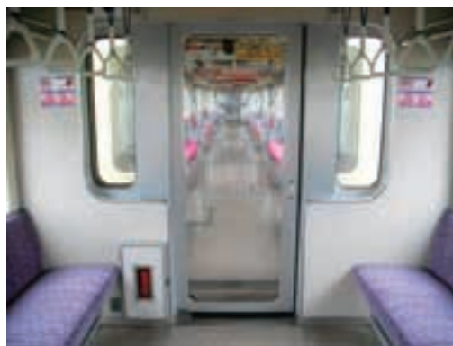
車両連結部の増設扉
