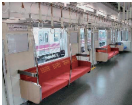
座席シートのバケット化及び座席中央部縦手すりの設置
