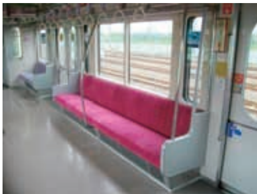
縦手すりの増設
