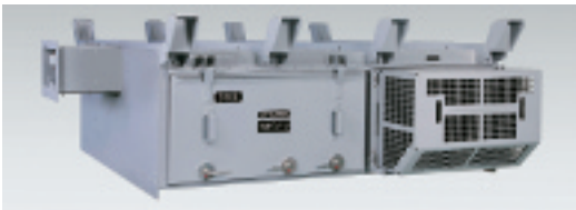
図-2 SiCを採用した補助電源装置
