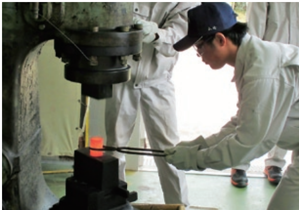
▲ 基礎実習（鍛造作業） Fundamental Practice (Hot Forging Practice)
