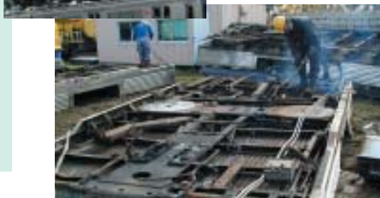
切断した車体はクレーン車で吊り上げ、台車と切り離して作業場へ移動します。
