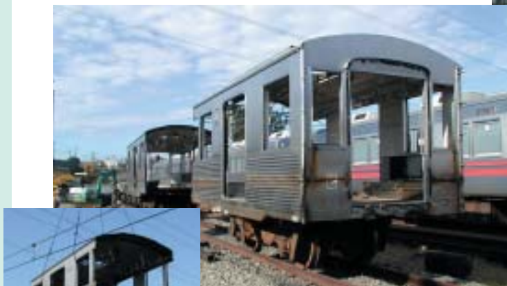
切断した車体はクレーン車で吊り上げ、台車と切り離して作業場へ移動します。
