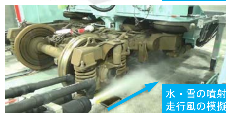
ブレーキ総合試験装置 (雪の降る環境等を模擬した状態での ブレーキ性能向上に向けた試験)
