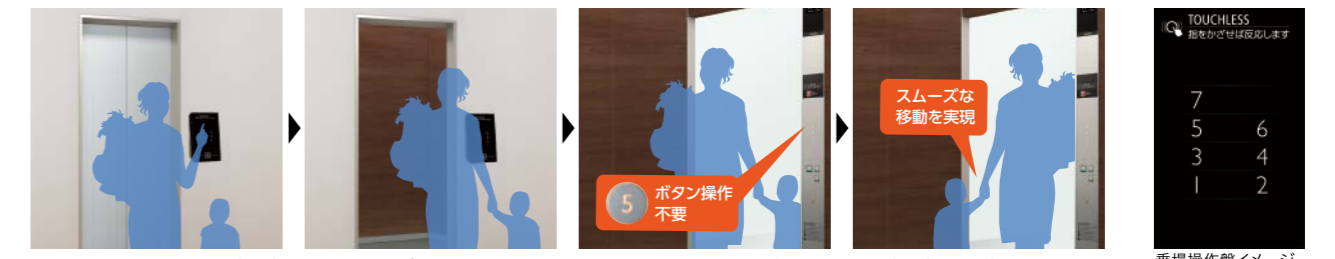
エレベーターホールにて先行(目的)階を登録します。エレベーターがエレベーターホールに到着します。エレベーターに乗り込むと、自動的に先行(目的)階が登録されます。先行(目的)階に到着します。乗場操作盤イメージ
