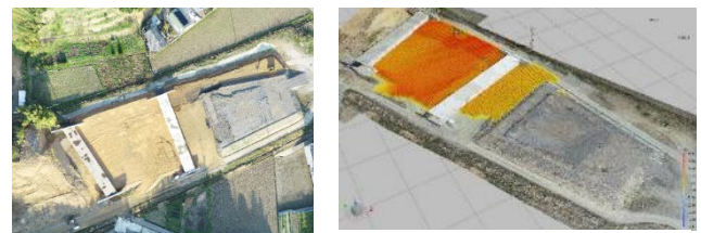
b. 土量算出画面（一例） 3D点群データ
