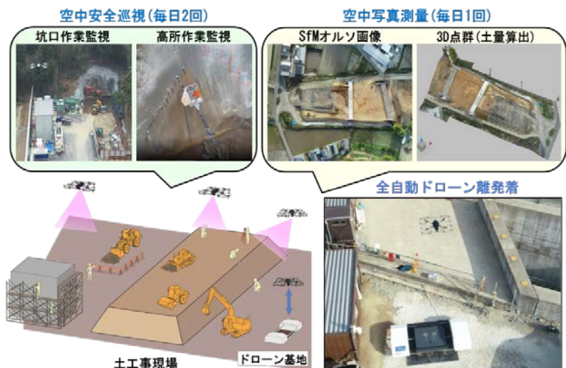
図-3 全自動ドローンによる測量・安全巡視
