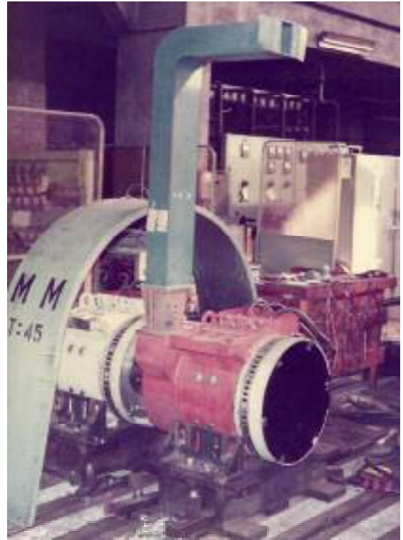
図-12 完成試験中のMT58 昭和48年 車体に模した風洞が取り付けられている
