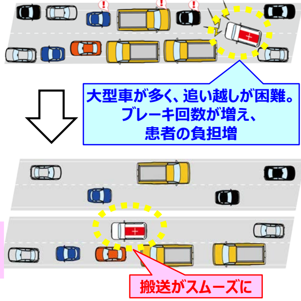
▼ 4車線化により可能となる スムーズな救急搬送
