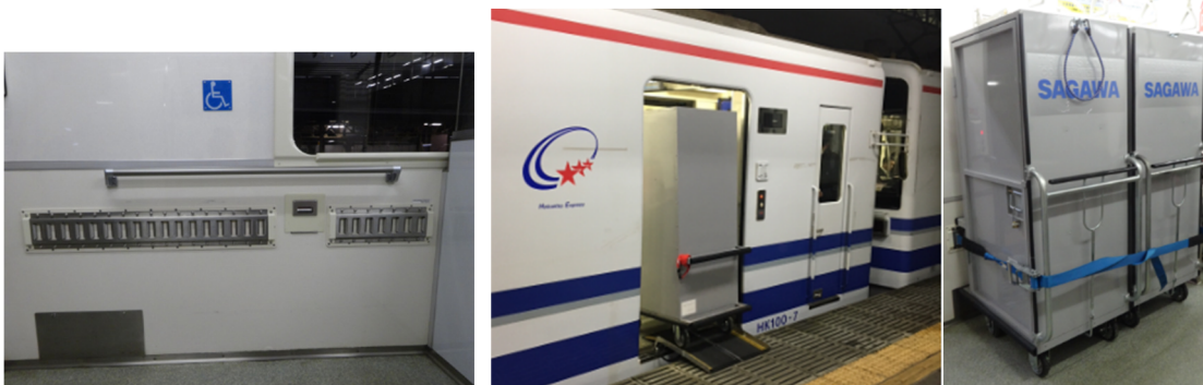
(撮影：DBJ) /左は車両にカーゴを固定する為のラッシングレール、 中・右はカーゴの車両への積み込み風景
