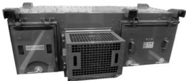
図4 SC104形VVVFインバータ装置
