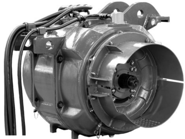
図8 MT79形主電動機
