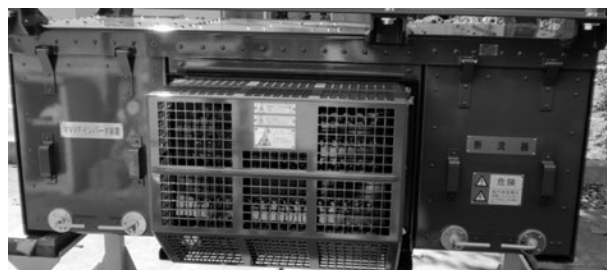
図5 SC105形VVVFインバータ装置
