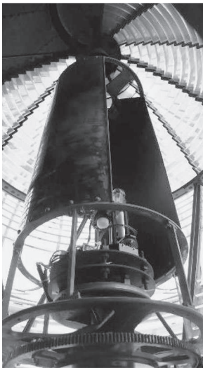
写真-1 緑剛埼灯台のレンズの中で回転する遮蔽板
