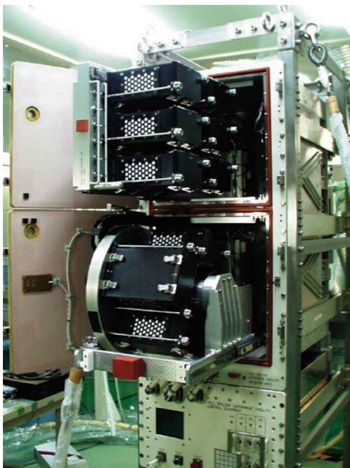
図 2.2-1 細胞培養装置外観 (左：扉を閉じた状態。右：微小重力区に 6 個、人工重力区に 4 個、中型キャニスタ装着した状態)
