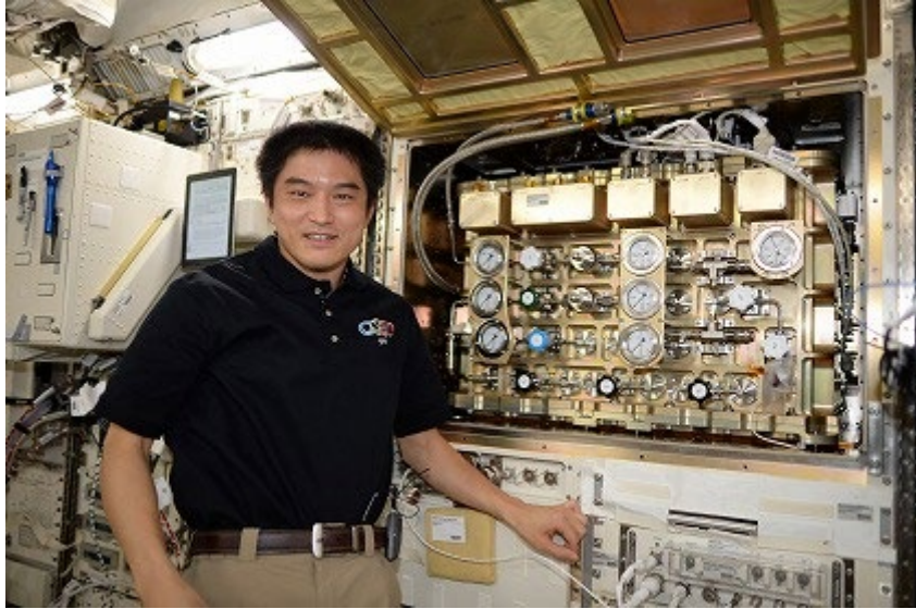
図 3.3-3 多目的実験ラック (MSPR) のワークボリュームへ設置された 燃焼実験チャンバ (CCE)
