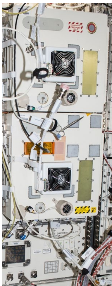
図 2.2-1 細胞培養装置外観 (左：扉を閉じた状態。右：微小重力区に 6 個、人工重力区に 4 個、中型キャニスタ装着した状態)
