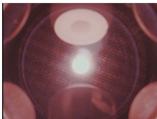
図 3.2-1 静電浮遊炉での浮遊と加熱
