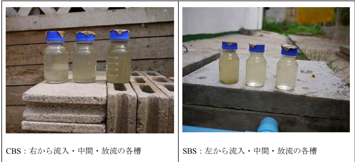
写真 3.3.1 サンプルングした汚水(2011年5月25日)
