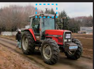
2月につくば市の農村工学研究所の敷地で行われた実験。トラクターの上部にGPSアンテナと「みちびき」アンテナが取り付けられている
