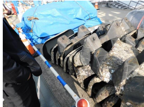
(交換された栈橋のフロート)
