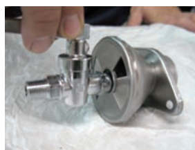
写真4 器具栓と給気口
