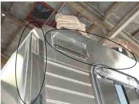
図 2 0 2両目 (Mu)①②位 妻構体上部の変形
