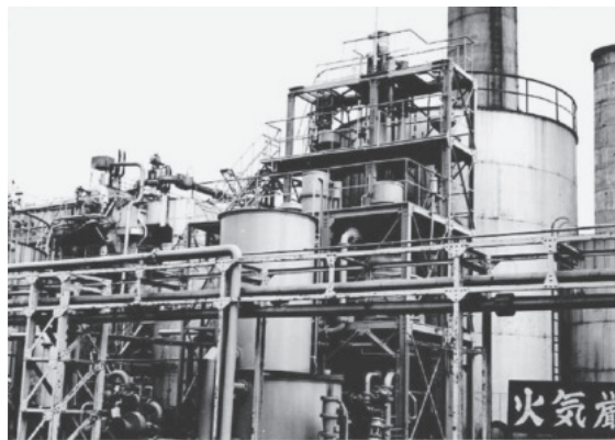
図 6.5 アサヒ・オルガノ式連続イオン交換装置 (7)
