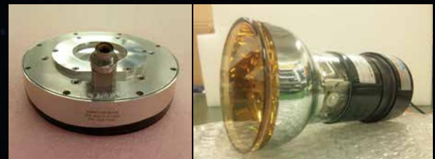
左:臭化ランタン 右:光電子増倍管 Left: Lanthanum bromide Right: Photomultiplier tube
