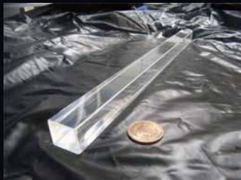
図3：タングステン酸鉛結晶シンチレータ(PWO) Figure 3: Lead tungstate crystal scintillator (PWO)
