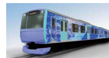
ハイブリッド車両(燃料電池)試験車両 FV-E991系
