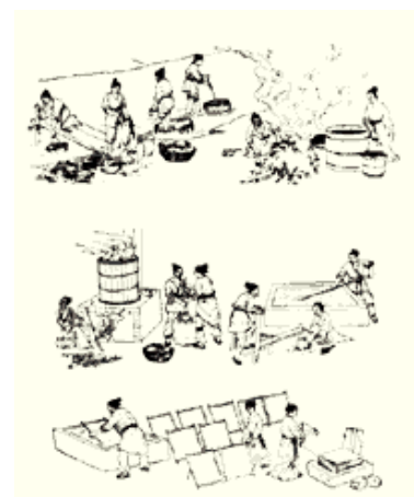
漢の時代の製紙工程(潘吉星著「中国製紙技術史」より)
