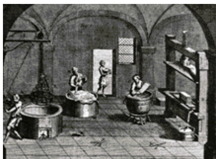
第1図 紙のサイズ (ドゥ・ラ・ランドの製紙術 [Karl Trobas; ABC des Papiers より])
