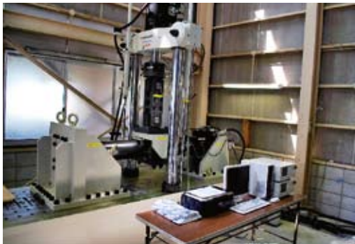
◀ 300kN 油圧サーボ2軸疲労試験装置 The 300kN hydraulic servo test system
