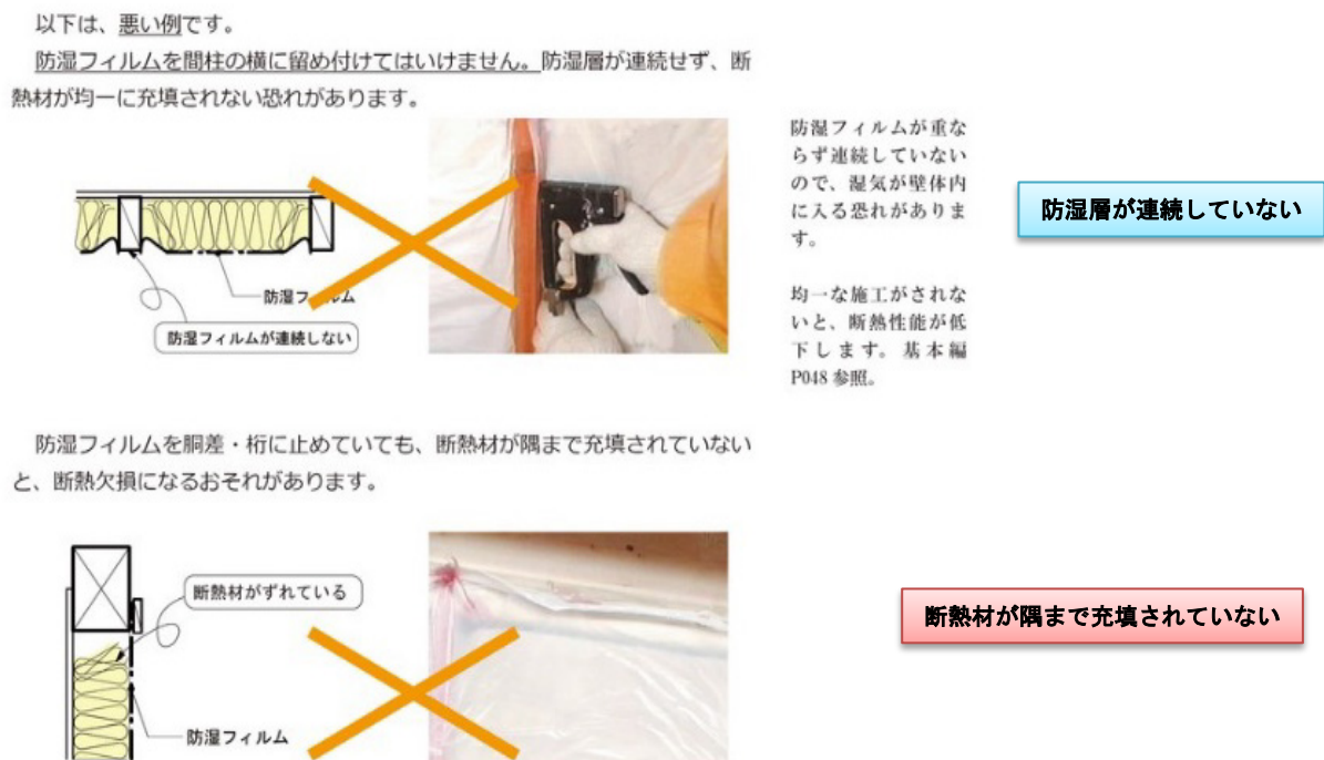
図 5.5 繊維系断熱材による不適切な防湿フィルムの施工例
