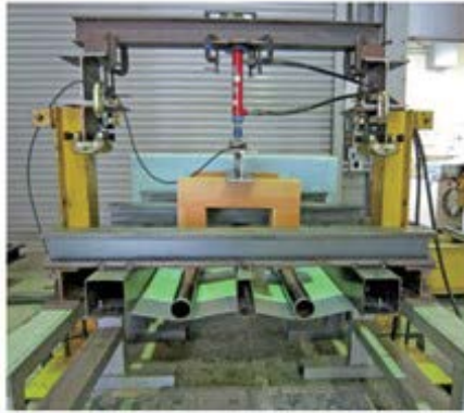
a. 鋼管を用いた線荷重載荷試験
