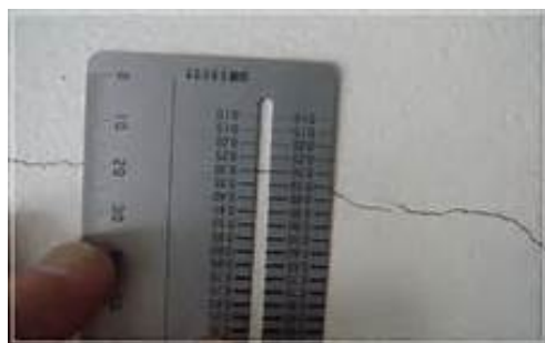
写真 3.2.9 ひび割れ幅を知るためのクラックスケールの例
