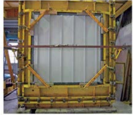
b. 圧力箱を用いた耐風圧性試験
