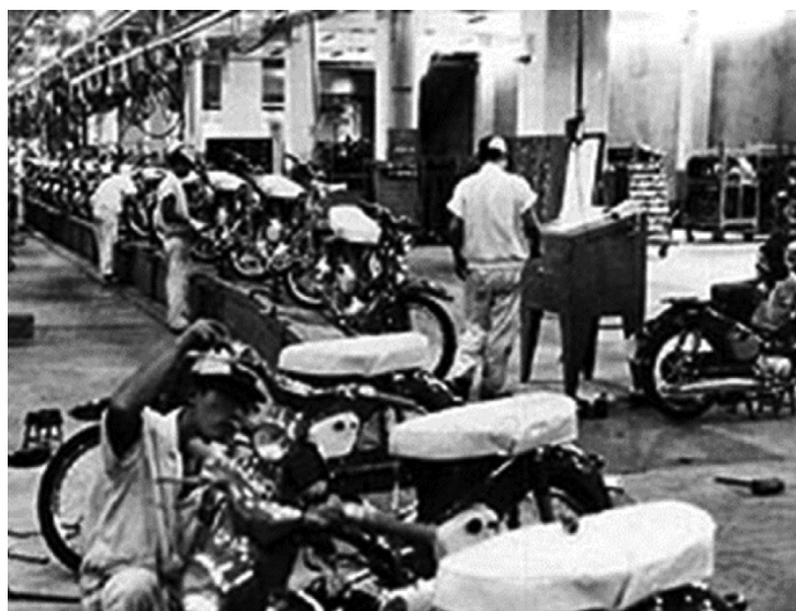
写真1●鈴鹿製作所のスーパーカブ組立ライン
