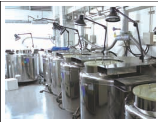
液体窒素凍結保存システム
