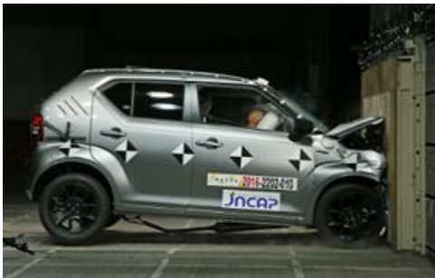
（前面衝突試験の様子）
