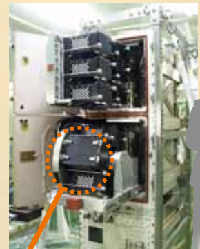
軌道上でのマウスの飼育。飼育ケージを6個ずつ「きぼう」の細胞実験装置(CBEF)の上段(無重力環境)と中段(人工重力環境)にセットして飼育する。
