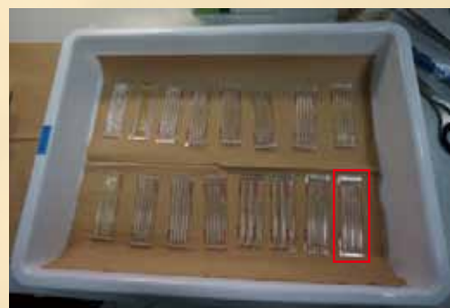
実験後、地球に戻ってきたタンパク質の容器 (赤枠の大きさ 縦約10cm×横約3cm)。
