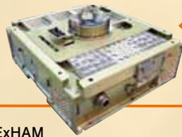
ExHAM (簡易曝露実験装置)本体。タイプ1のサンプル(10cm×10cm×2cm)であれば、上面に7個、側面に13個搭載することができる。
