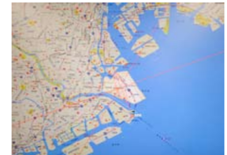
各地のセンサ局が該当電波を受信し、その方向が地図上に表示される。赤いラインが交わった地点が発射源。
