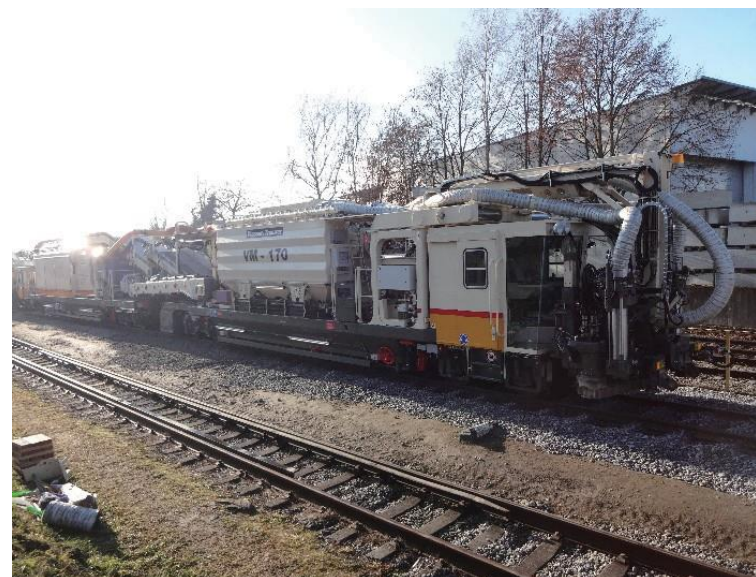
プラーサー社／オーストリア 道床掘削車 (JUMBO)
