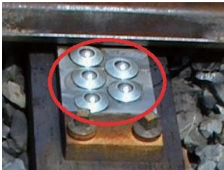
フォスローナルディックスイッチシステム社/スウェーデン ボールベアリング床板
