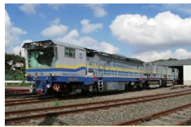
スペノ社製 レール削正車
