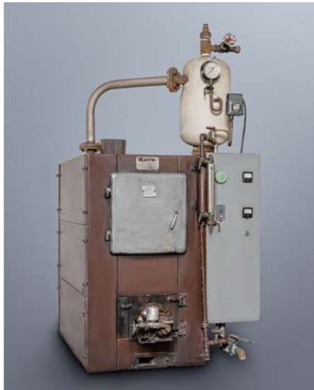
(株)三浦製作所(現三浦工業(株))製小型貫流ボイラー「ZP型」は、わが国のボイラー市場、さらには国民の生活様式を変えた象徴的装置である。1959(昭和34)年の労働安全衛生法などの法令改正で、運転圧力が10気圧以下かつ伝熱面積10m<sup>2</sup>以下の小型貫流ボイラーは無免許で使えるようになり、それを受ける形で開発された。このボイラーは、多数の水管と管寄せだけからなる蒸発部をもつ。水管がZ型状をしているので、名称に“Z”が付いている。稼働時の圧力も低く、保有水量も少ないことから安全性が高く、蒸気も早く発生して作業性がよい。また、従来のボイラーに比べて設置面積が小さいこと、独自のZ型水管の缶体構造から稼働中や夜間の停止中の放
