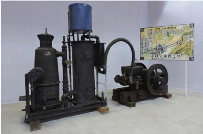
わが国の戦中戦後の石油欠乏期、政府による木炭ガス発生装置普及・奨励の施策もあって、民需動力の多くを木炭ガス機関が支えた。木炭ガス機関は、木炭から一酸化炭素を抽出する“木炭ガス発生炉”、異物を除去し体積効率を高める“冷却清浄機”、そして“吸入ガス発動機”からなる。各地で工夫開発が行われ、1955(昭和30)年前後まで活用されたが、その後、石油事情の好転と始動時間の長さ、トルク不足などの構造的欠点が原因で消滅した。木炭ガス機関は、原動機の歴史からは外れた一時的な存在であるが、昨今のエネルギー問題への対応策として注目される“バイ
