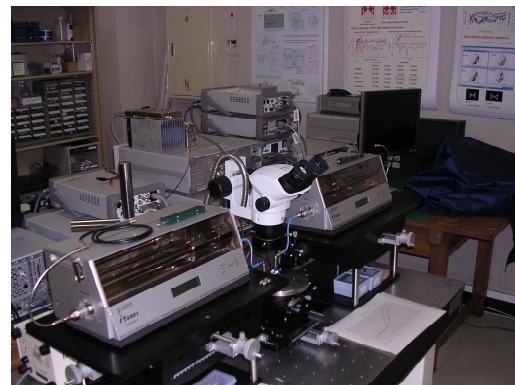
図.12 自動ロードプル測定系 (電気通信大学)
