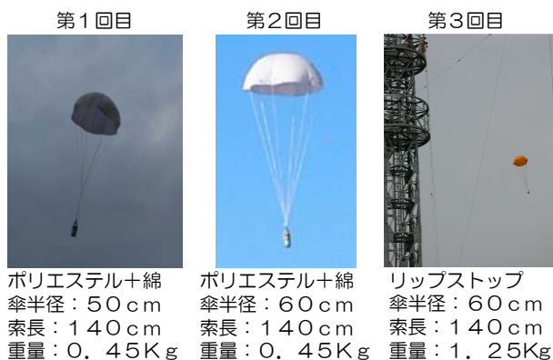
図3 パラシュートの材質、大きさ、重さの実験
