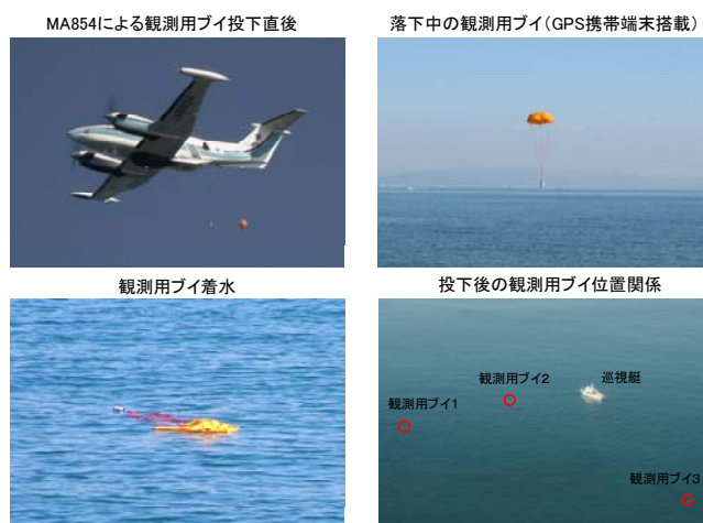
図5 航空機による観測用ブイ投下実験
