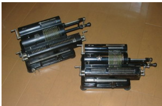
写真 3 左がタイガー計算器製で、右は日本計算器製（飯島仁氏提供）。日本計算器は、タイガーのコピー版であることがよく分る。
