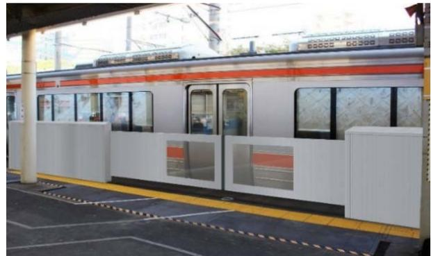
可動柵設置のイメージ（写真は金山駅の試作機）
