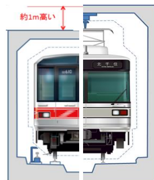
集電方式とトンネル高さの比較
