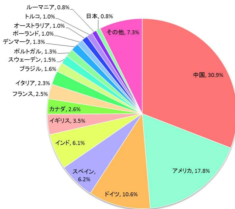
図 2 2014 年までの累積風力発電の導入割合<sup>(4)</sup> (全世界で約 370GW)
