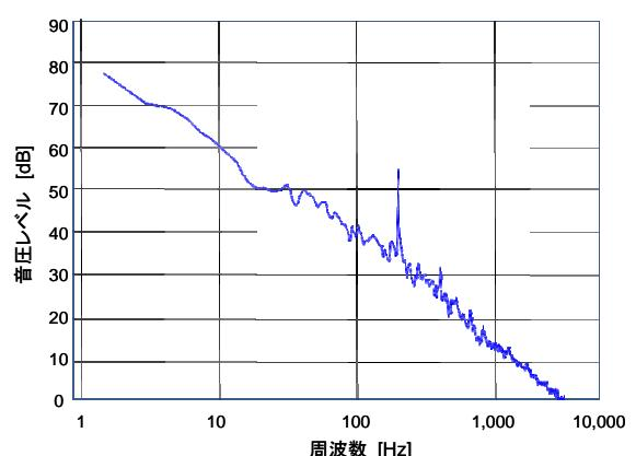
図 7 純音性成分を含む風車騒音の例 (FFT 狹帯域分析)
