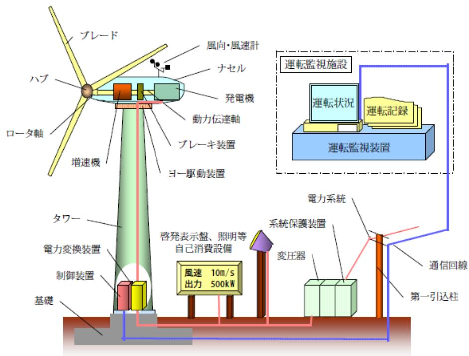
図 1 風力発電施設の機器構成例<sup>(3)</sup>
