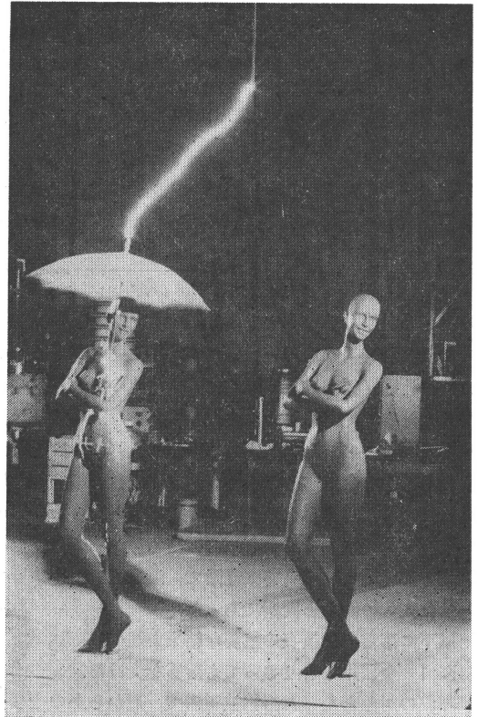
第4図 落雷を模擬する放電は、洋傘が頭上に突き出た模擬人体に進展した。
